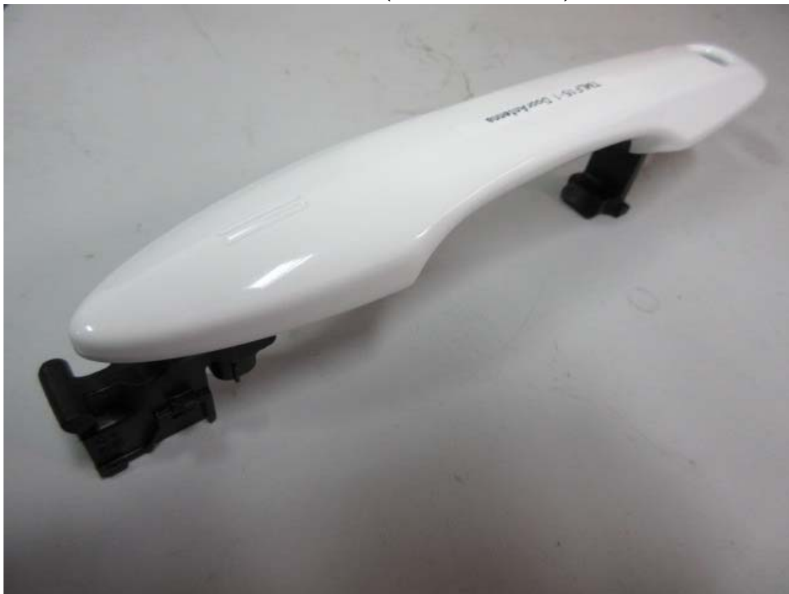
外觀照一(Door Antenna)
