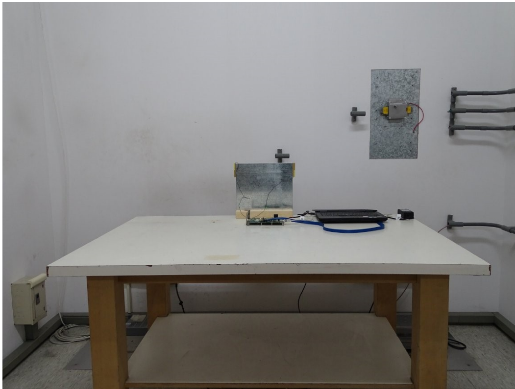
測試相片：電源端點測試 正面相片
