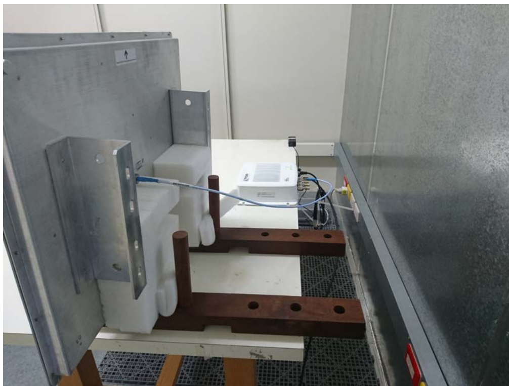
圖二. 電源傳導干擾測試(後)
