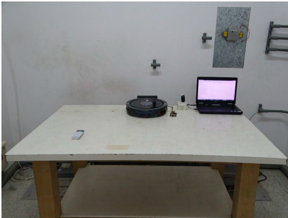
測試相片：電源端點測試 正面相片
