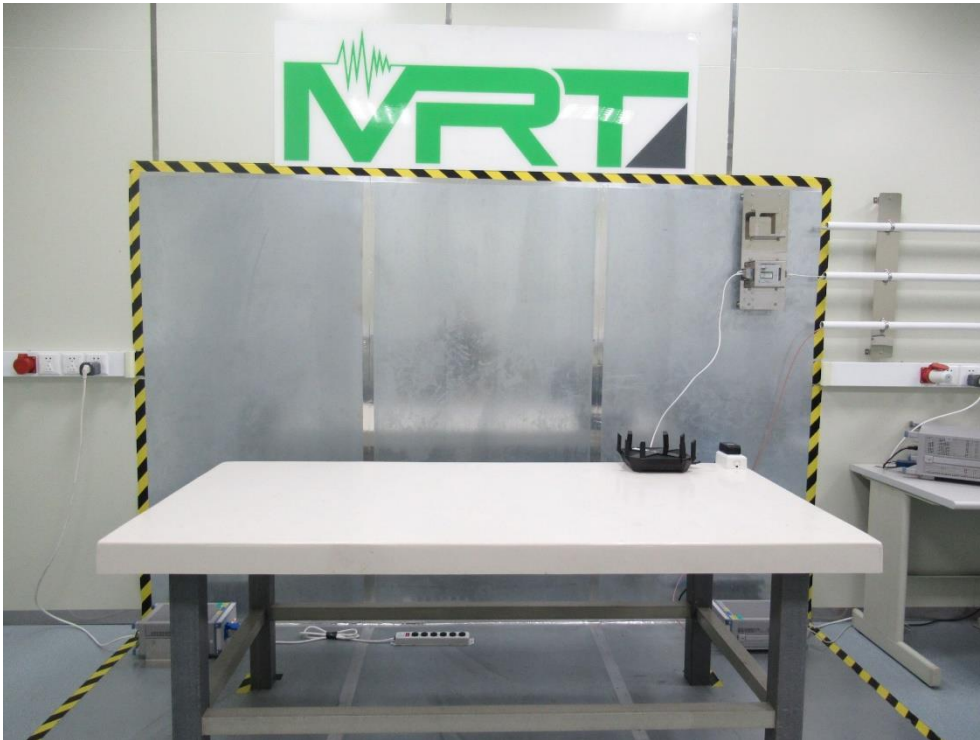
電源傳導測試 側面照 - 0.15MHz ~ 30MHz (Normal Mode)
