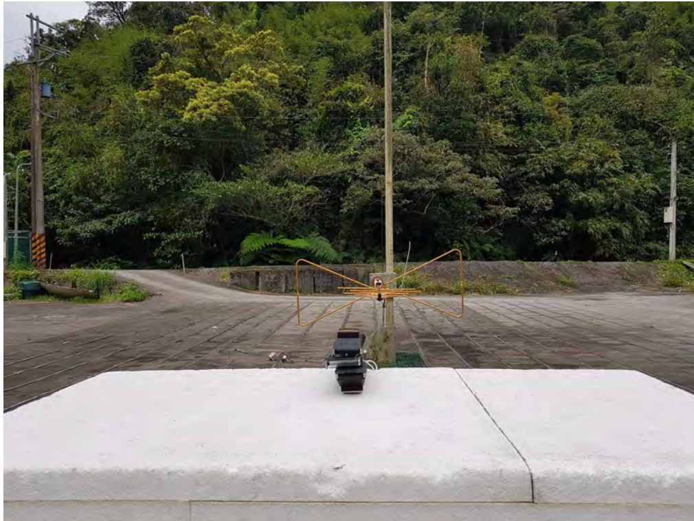
輻射干擾量測之配置照片(1G 以下)
