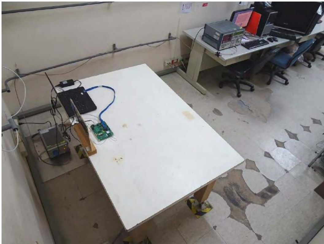
測試相片：電源端點測試 背面相片
