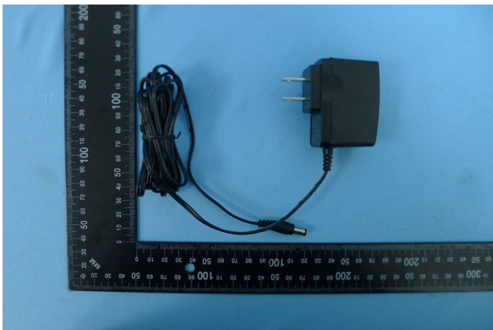
(8) 電源供應器照片
