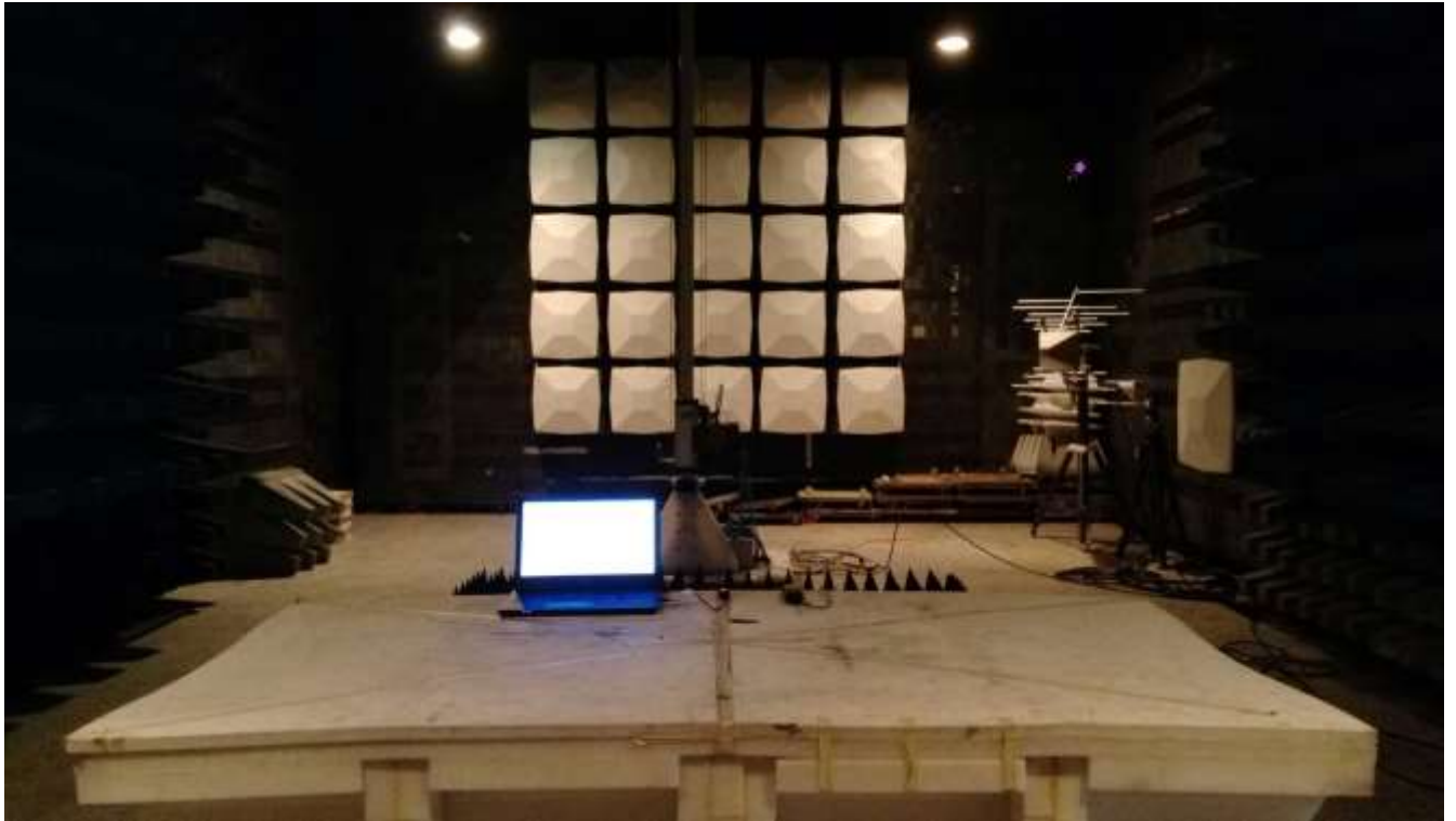
輻射干擾量測之配置照片(1G 以上)
