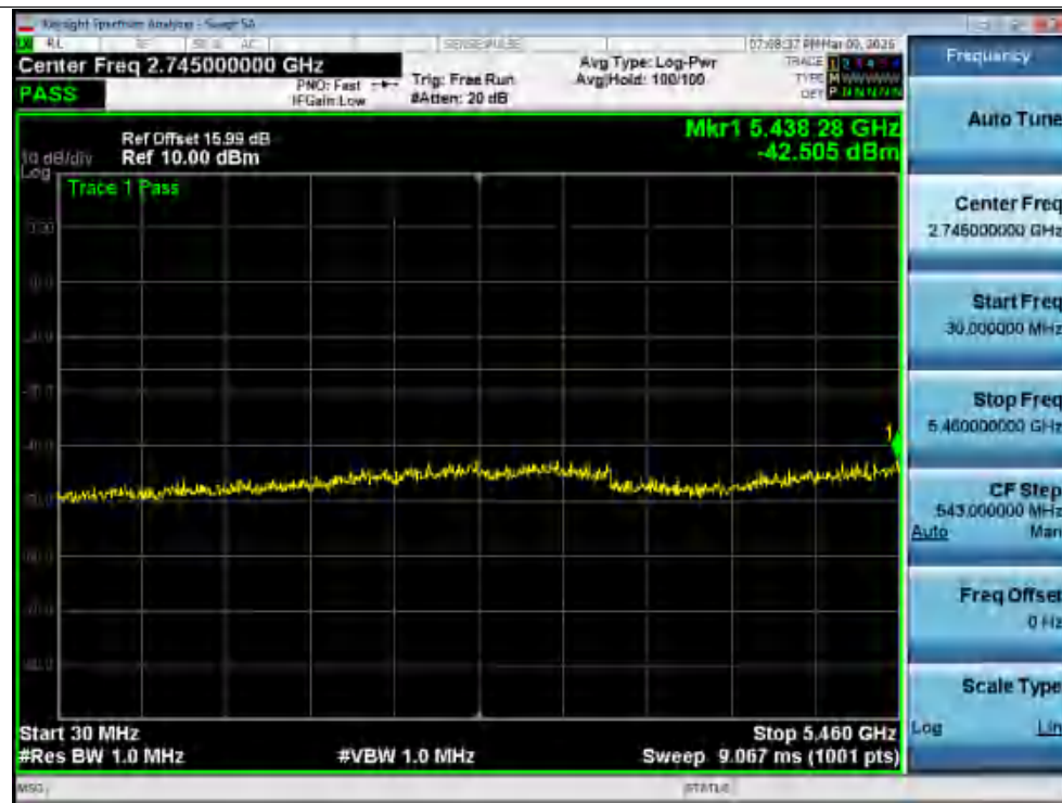
Tx. Spurious NVNT n20 5700MHz Ant1 @ 5460MHz-5470MHz
