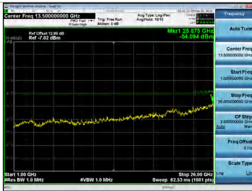
Rx. Spurious NVNT n20 5700MHz Ant1 @ 1000MHz-26000MHz
