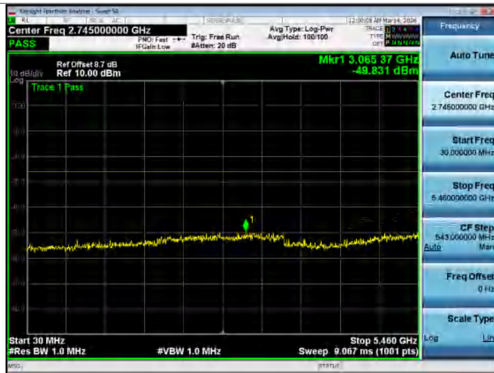
Tx. Spurious NVNT a 5700MHz Ant2 @ 5460MHz-5470MHz
