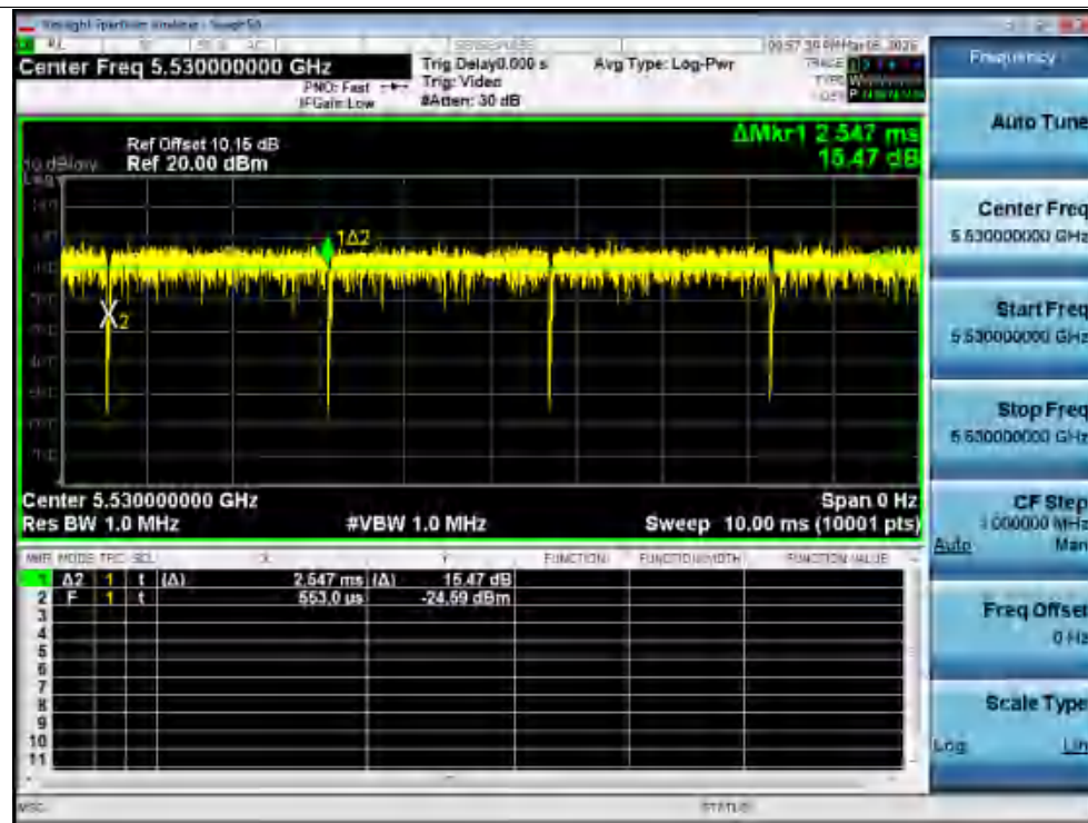
Burst Length NVNT ax80 5610MHz Ant1
