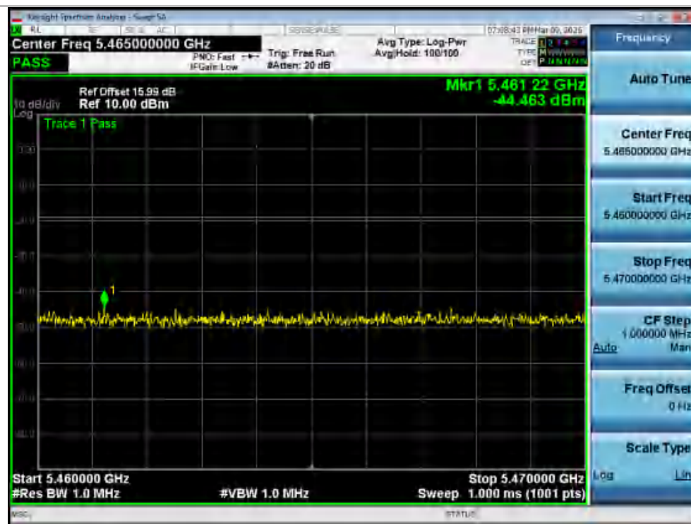
Tx. Spurious NVNT n20 5700MHz Ant1 @ 5460MHz-5470MHz
