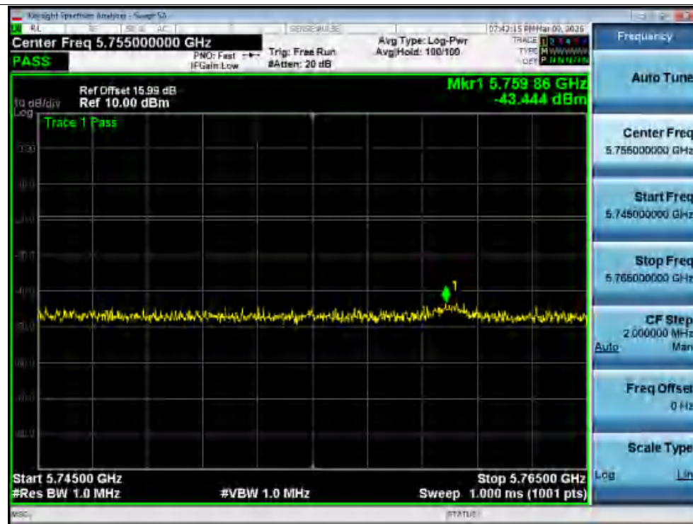
Tx. Spurious NVNT ax20 5700MHz Ant1 @ 5765MHz-26000MHz
