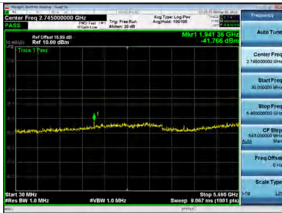
Tx. Spurious NVNT ac20 5700MHz Ant1 @ 30MHz-5460MHz
