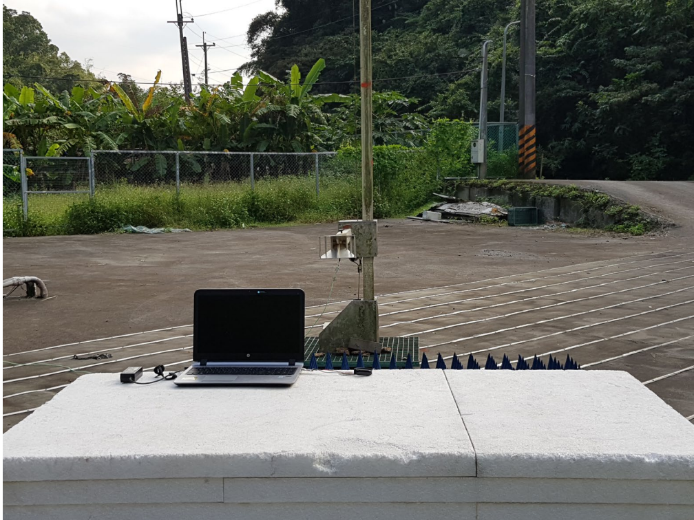
輻射干擾量測之配置照片(1G 以上)
