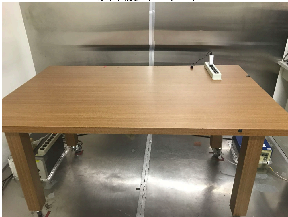
測試照片 傳導干擾量測之配置照片
