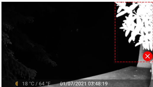
Figura 10: Evite los obstáculos de primer plano frente a la cámara
