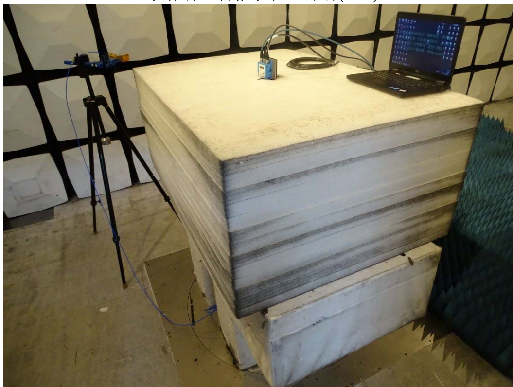
測試相片：輻射測試 正面相片(Horn)
