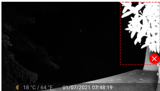
Figura 11: Evite los obstáculos de primer plano frente a la cámara
