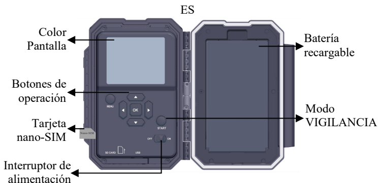
Figure 4 : Vue intérieure et carte SIM préinstallée
