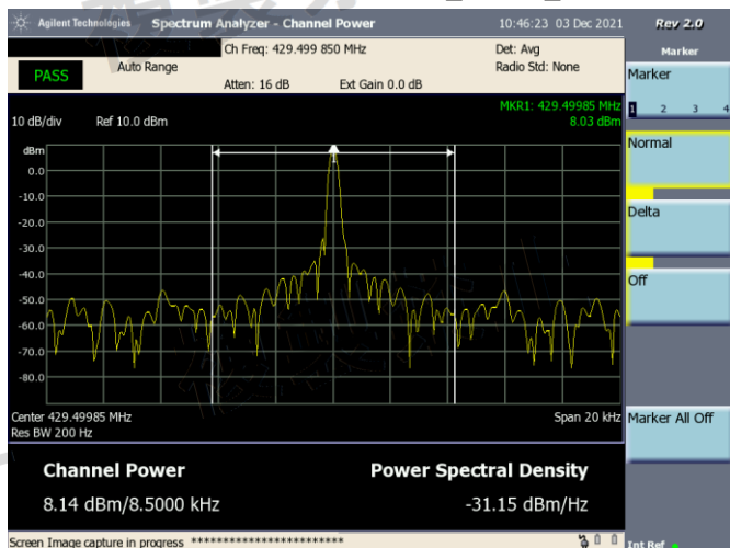
図14-1.隣接チャネル漏洩電力_CH21_搬送波
