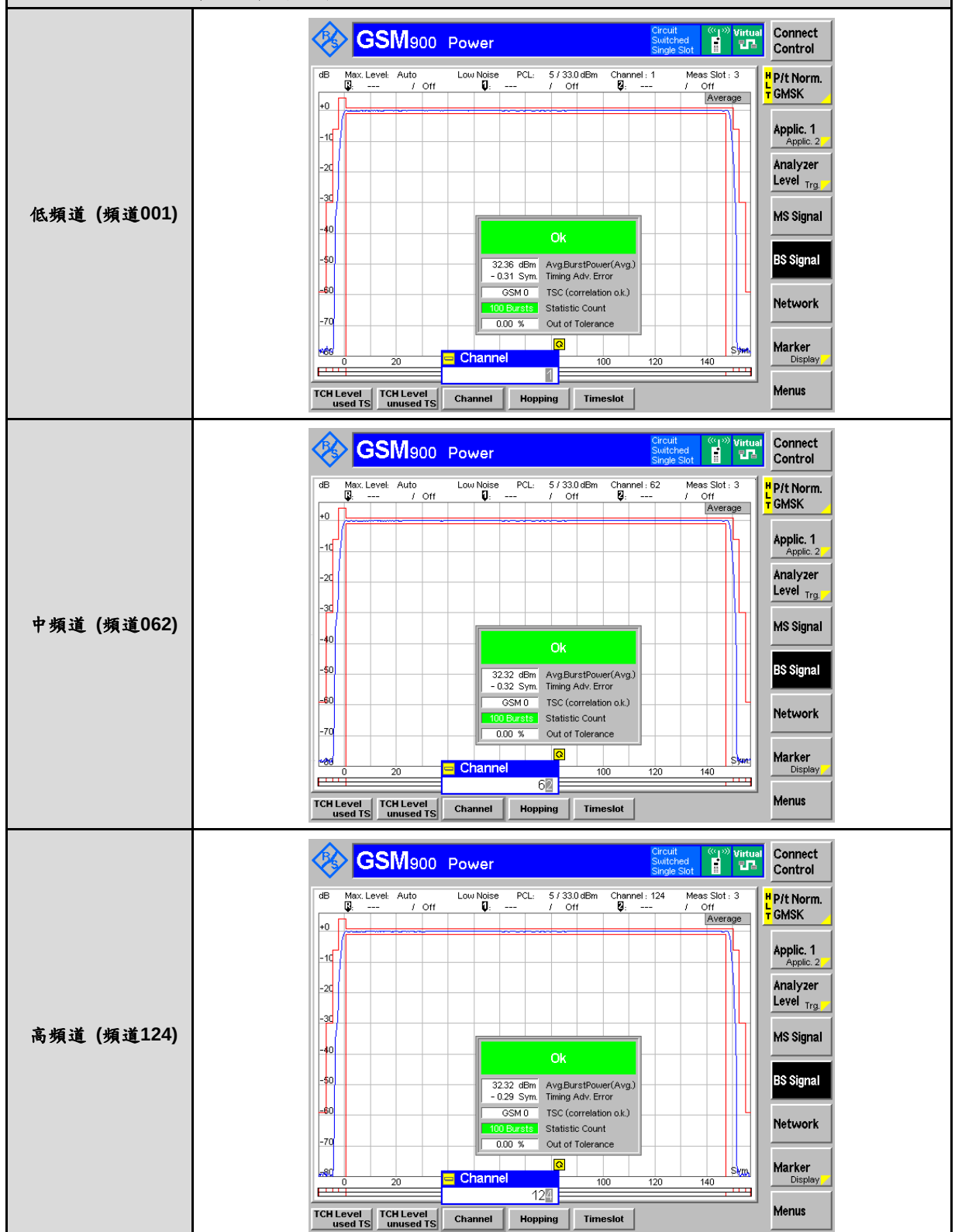
GSM900低壓-正極限業訊功率/時間關係圖
