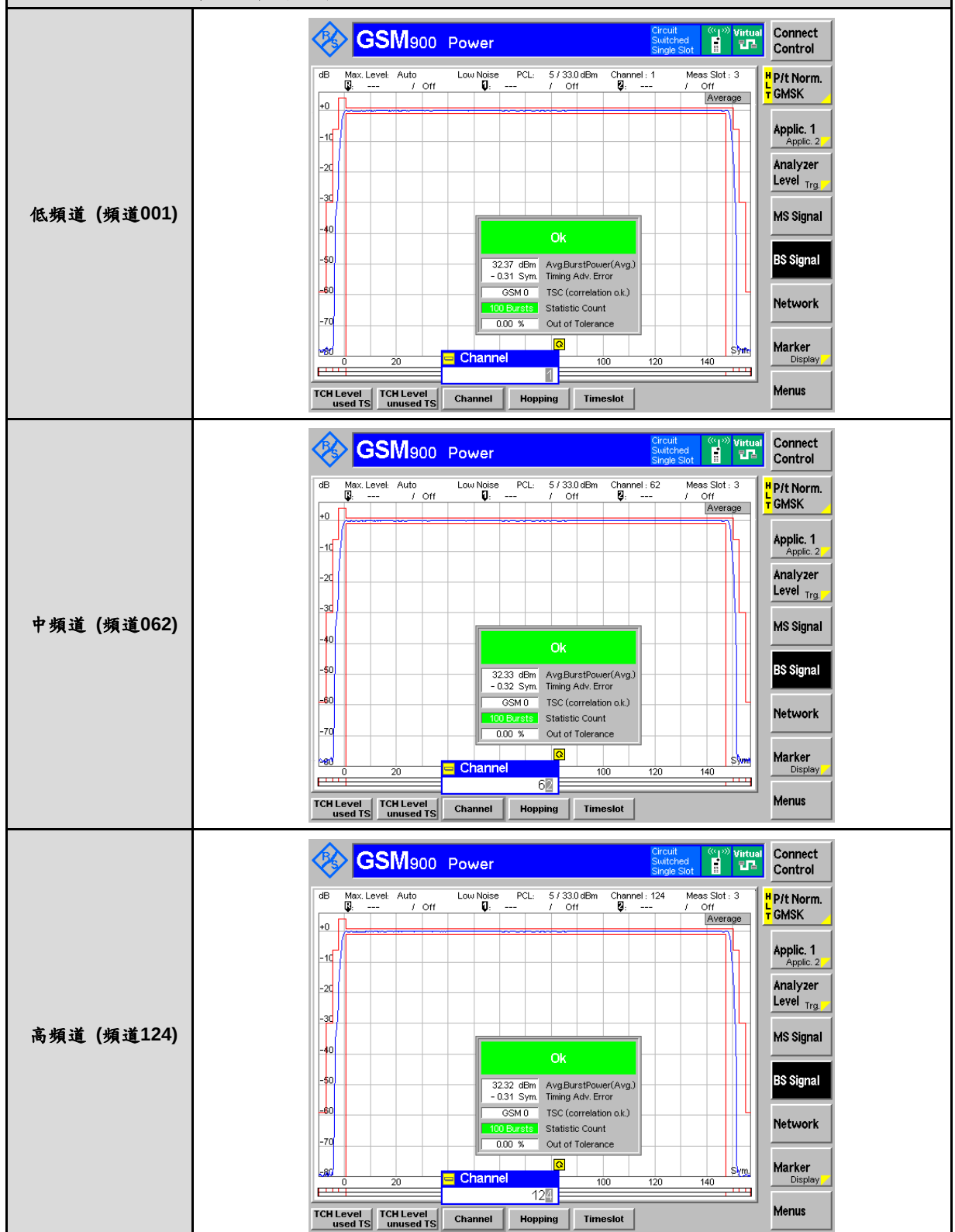
GSM900低壓-負極限輻訊功率/時間關係圖
