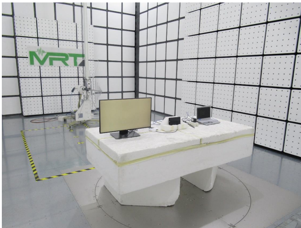
輻射測試 Above 1GHz
