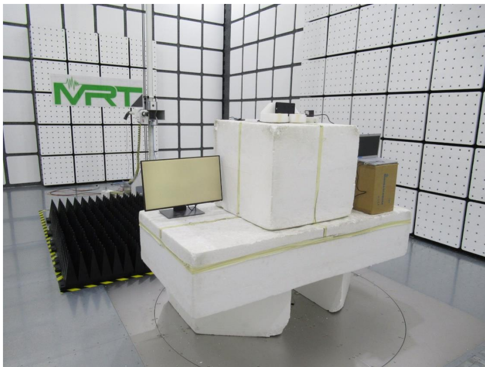
輻射測試 Above 1GHz
