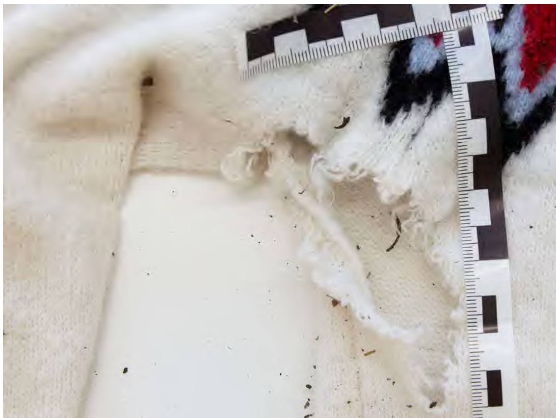
Figur 2. Skadan vid ärmhålssömmen.
