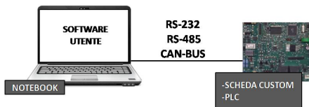
Figura B: esempio di comunicazione seriale locale
