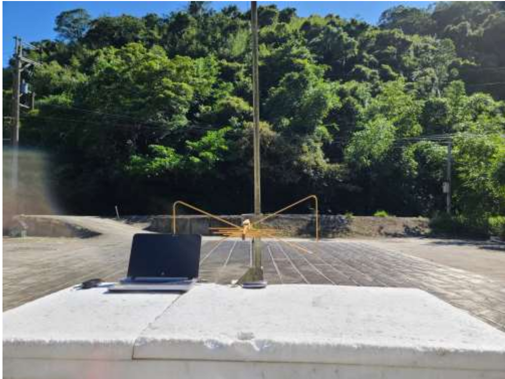
輻射干擾量測之配置照片(1 G 以下)
