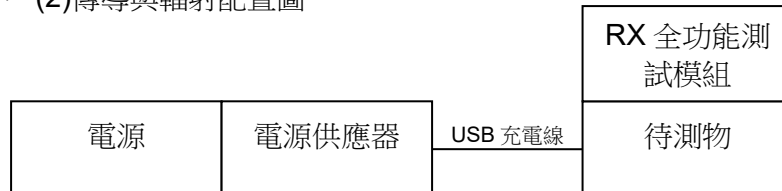
Qi 模式 C、(2)傳導與輻射配置圖
