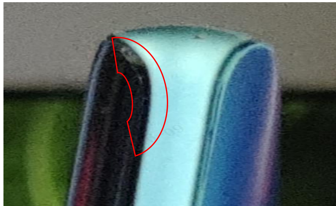
非原厂点胶屏幕边缘胶粗糙、凹凸不平
