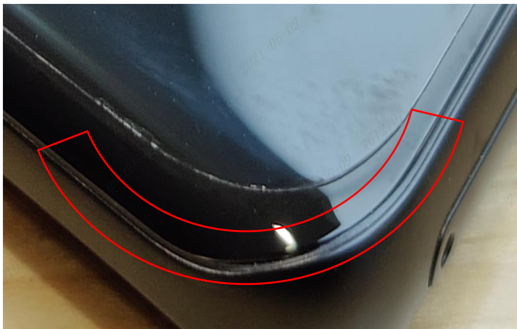
原厂点胶屏幕边缘胶均匀、平整
