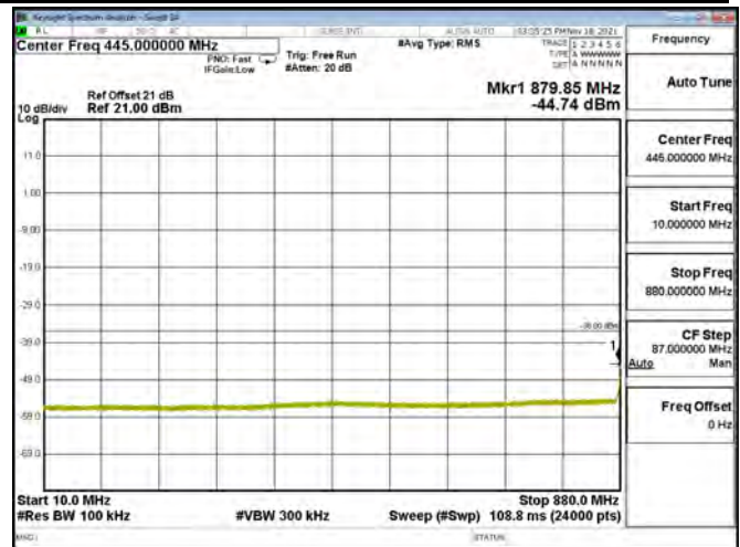
LTE BAND 08 - 10MHz - CH 21650 - QPSK[Full RB-50RB#0]
