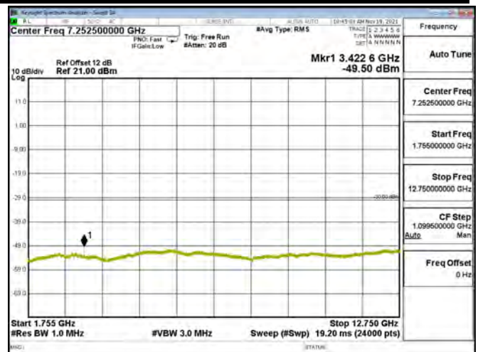
LTE BAND 03 - 20MHz - CH 19300 - QPSK[Partial RB(#0)-1RB#0]
