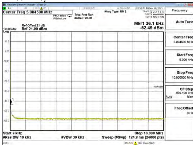
LTE BAND 08 - 10MHz - CH 21650 - QPSK[Partial RB(#0)-1RB#0]
