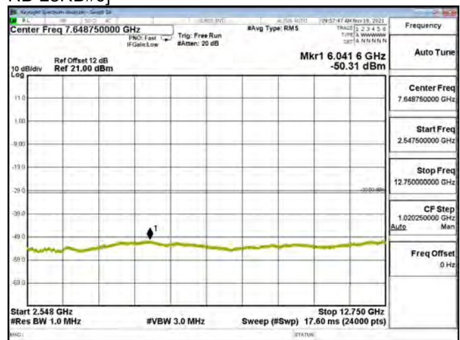
LTE BAND 07 - 5MHz - CH 21100 - QPSK[Full RB-25RB#0]
