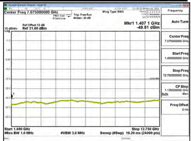
LTE BAND 28 - 5MHz - CH 27235 - QPSK[Partial RB(#0)-1RB#0]
