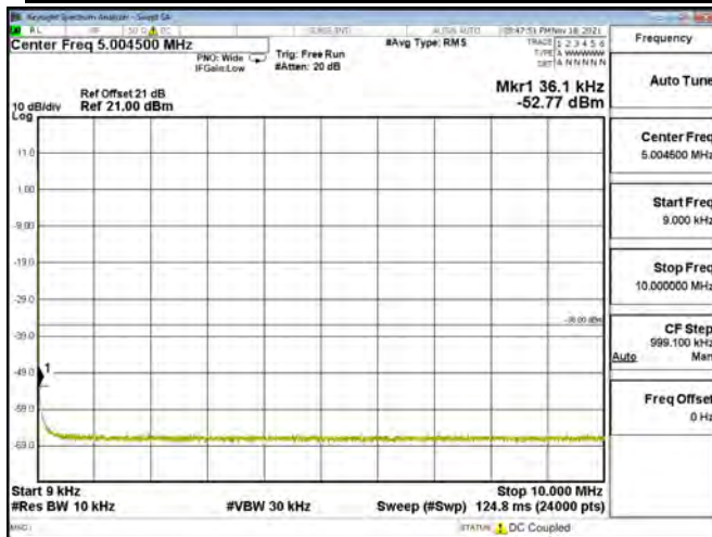
LTE BAND 07 - 5MHz - CH 21100 - QPSK[Full RB-25RB#0]
