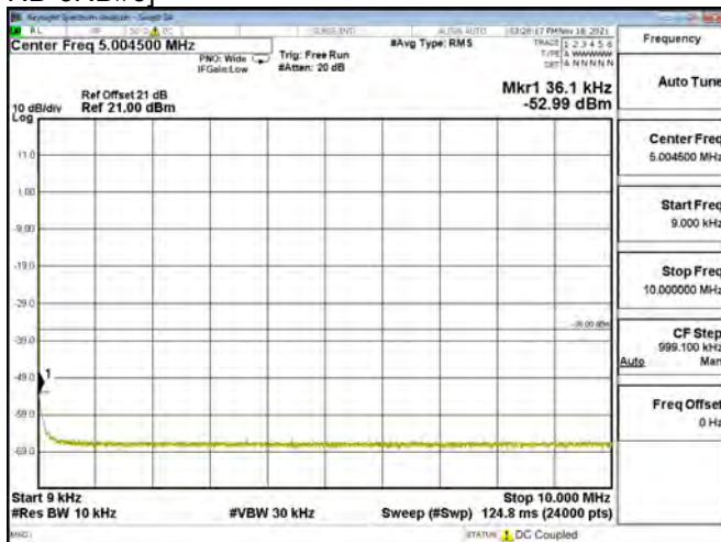
LTE BAND 08 - 1.4MHz - CH 21650 - QPSK[Partial RB(#0)-1RB#0]
