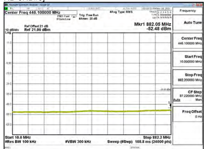
LTE BAND 08 - 1.4MHz - CH 21507 - QPSK[Partial RB(#0)-1RB#0]
