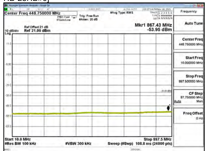
LTE BAND 08 - 5MHz - CH 21650 - QPSK[Partial RB(#0)-1RB#0]
