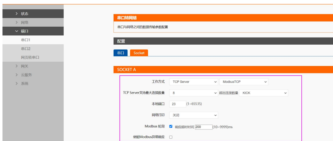
图 22. Modbus 协议转换配置界面
