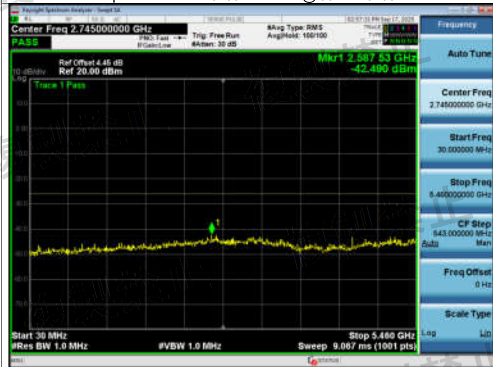
Tx. Spurious NVNT a 5700MHz Ant1 @ 5460MHz-5470MHz
