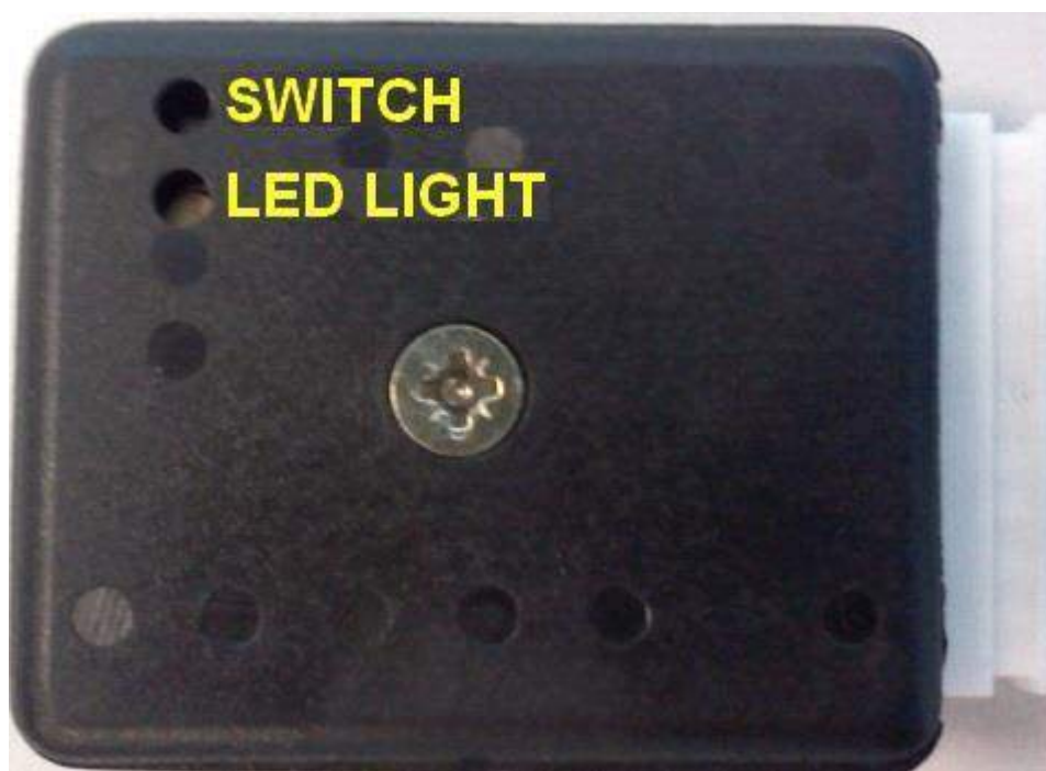
Рис.76 Расположение кнопки и светодиода адаптера
