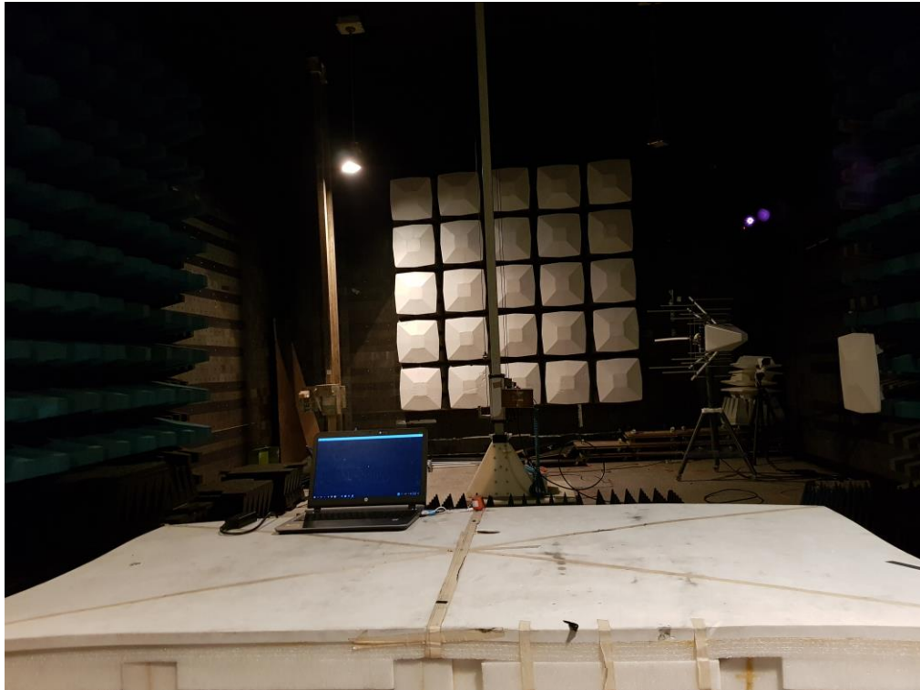
輻射干擾量測之配置照片(1G 以上)
