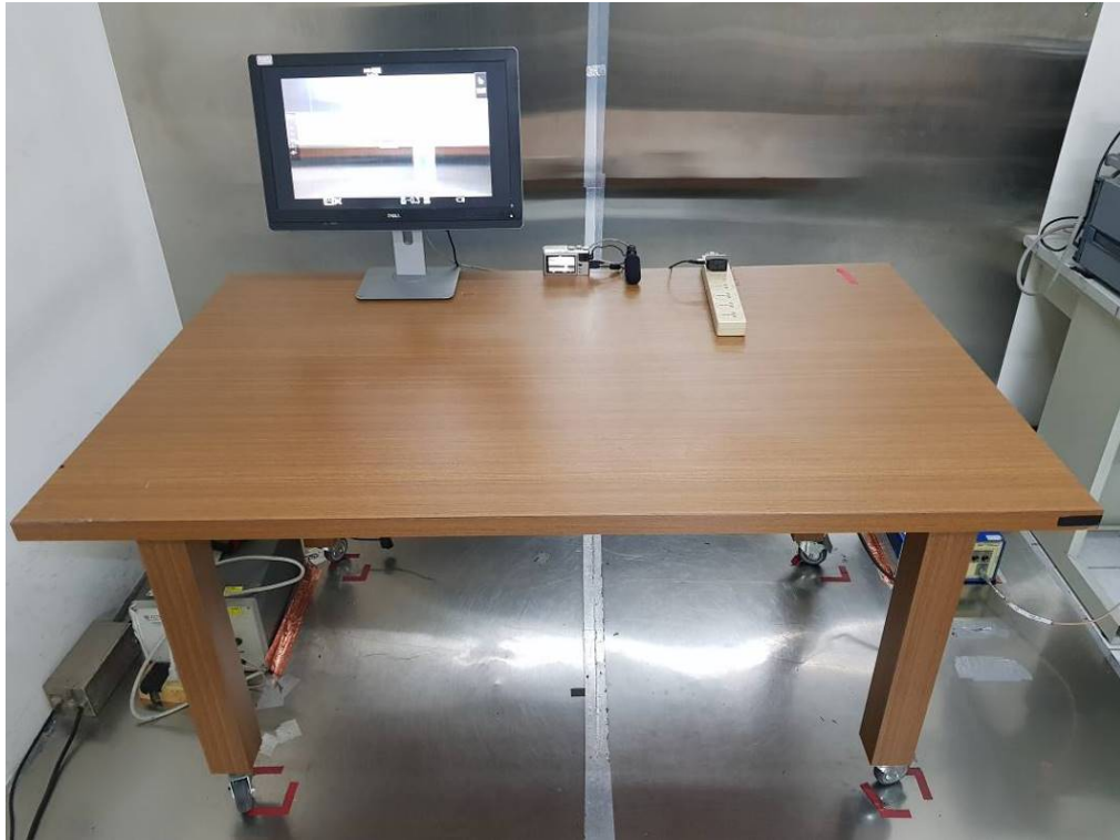
測試照片 傳導干擾量測之配置照片
