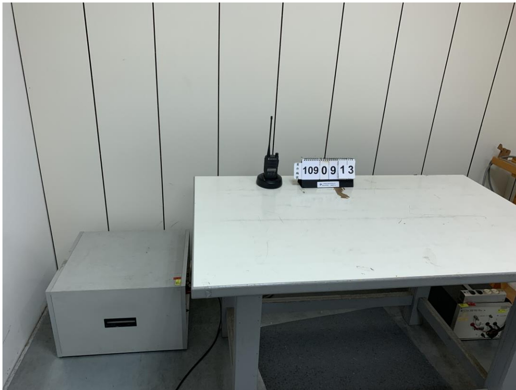
電源傳導最大干擾電壓擺置實際照片(正面)
