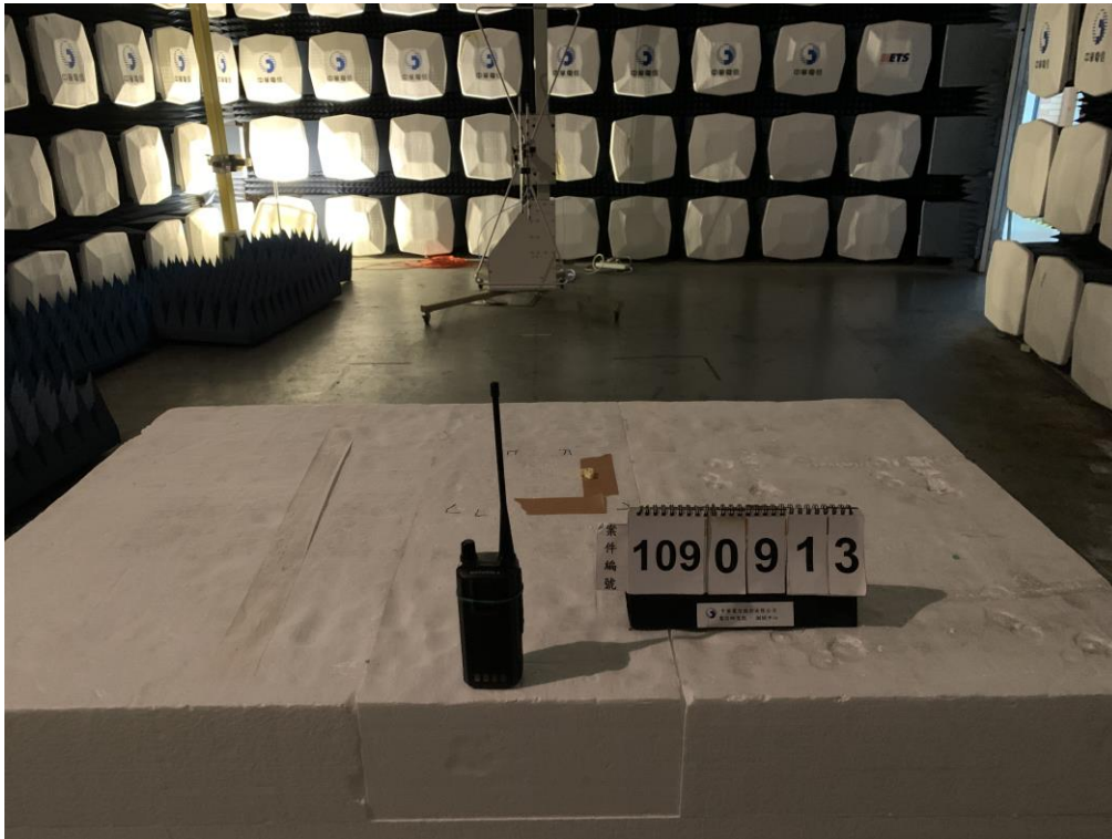
1GHz 以下輻射電場強度最大干擾擺置實際照片(正面)
