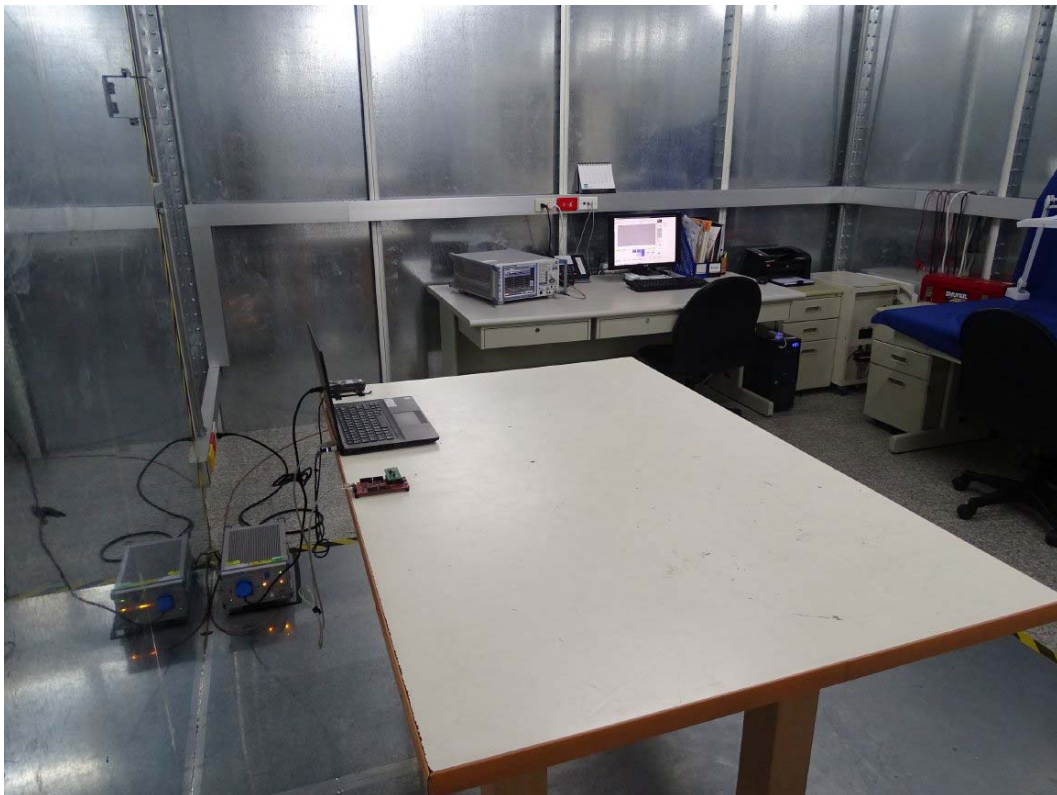
測試相片：電源端點測試 背面相片
