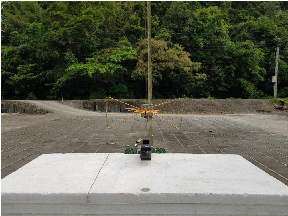
輻射干擾量測之配置照片(1G 以下)
