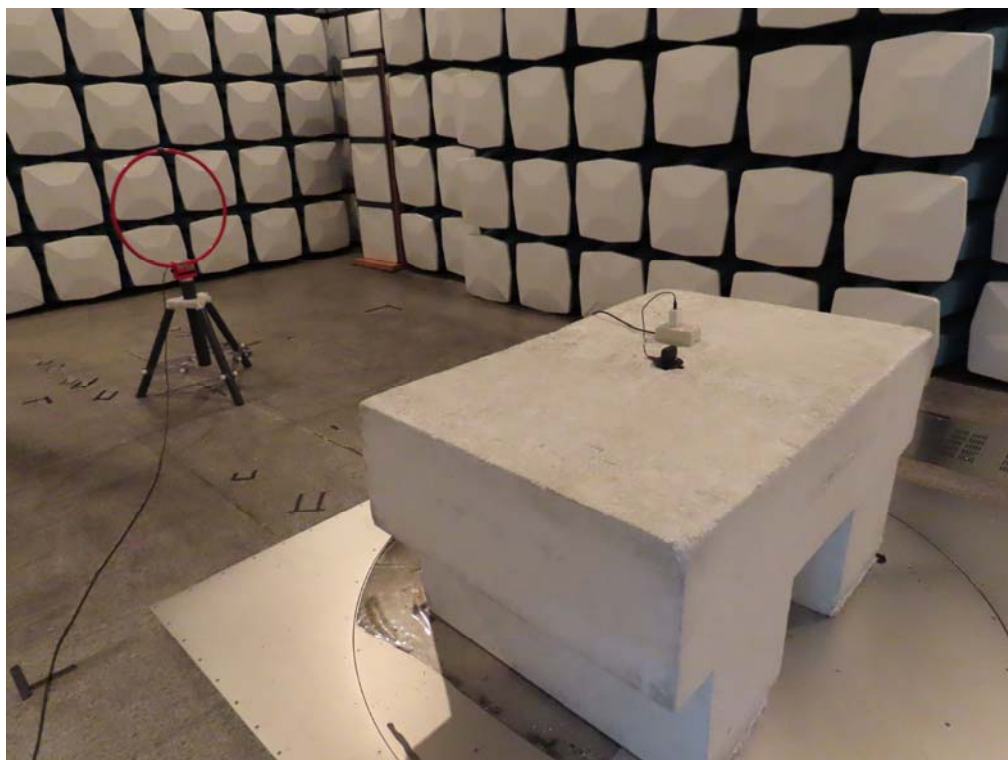
測試相片：輻射測試 背面相片-LOOP (無線充電)
