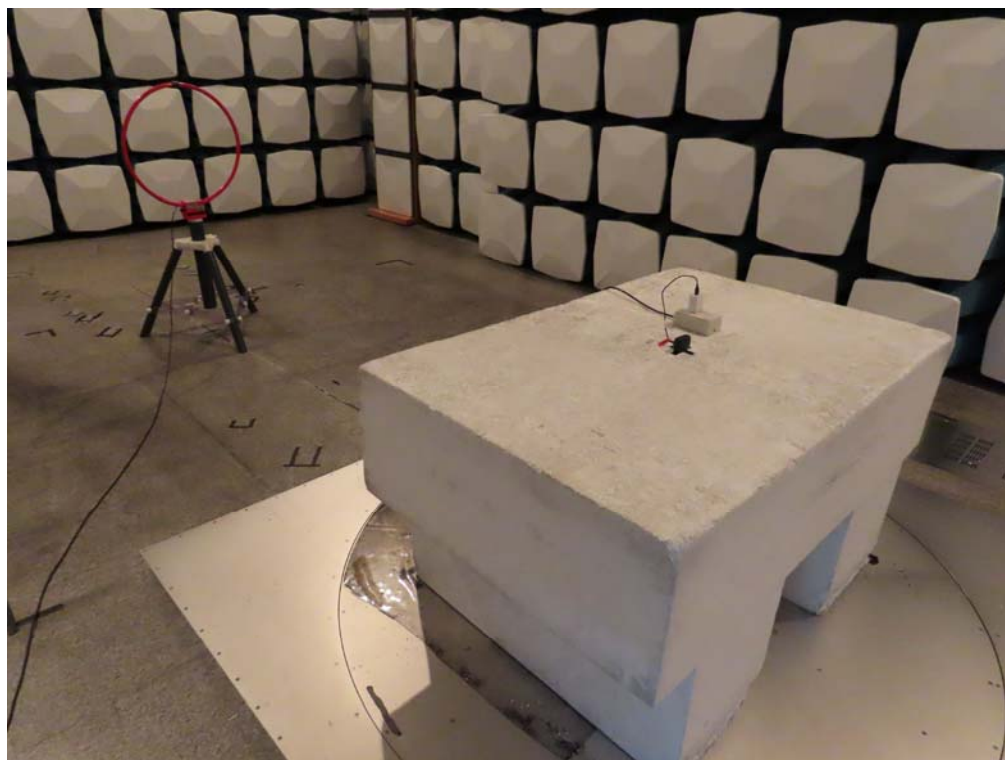
測試相片：輻射測試 背面相片-LOOP (充電)
