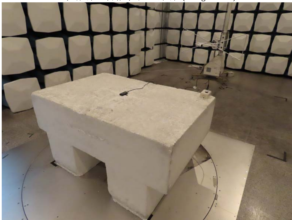
測試相片：輻射測試 正面相片 (Charger mode)
