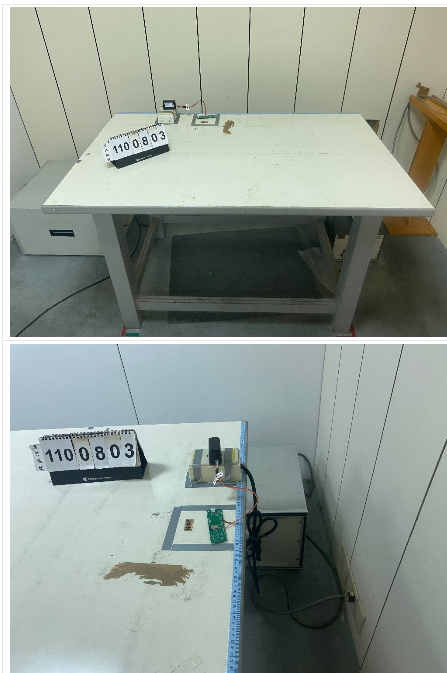
電源線傳導最大干擾擺置實際照片
