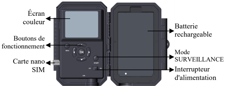
Figure 4 : Vue intérieure et carte SIM préinstallée
