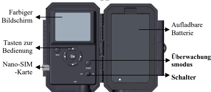
Abb. 4: Innenansicht und vorinstallierte SIM-Karte
