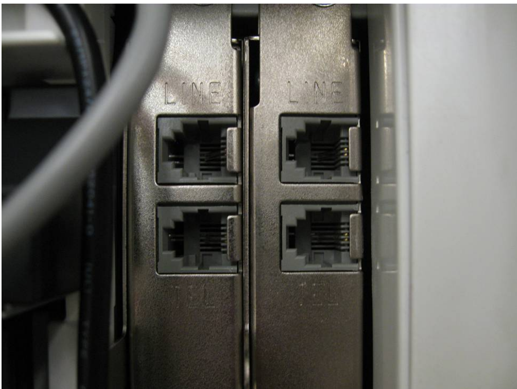
圖 10、設備傳真埠照(適用機種: 廠牌:DEVELOP / 型號: ineo+ 554e、ineo+ 454e、DEVELOP ineo+ 554e、DEVELOP ineo+ 454e)
