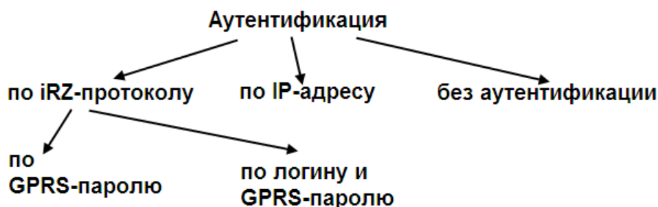
Рис. 4.6 Типы аутентификации клиентов при подключении к модему-серверу
