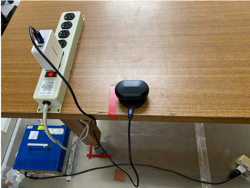
測試照片 傳導干擾量測之配置照片
