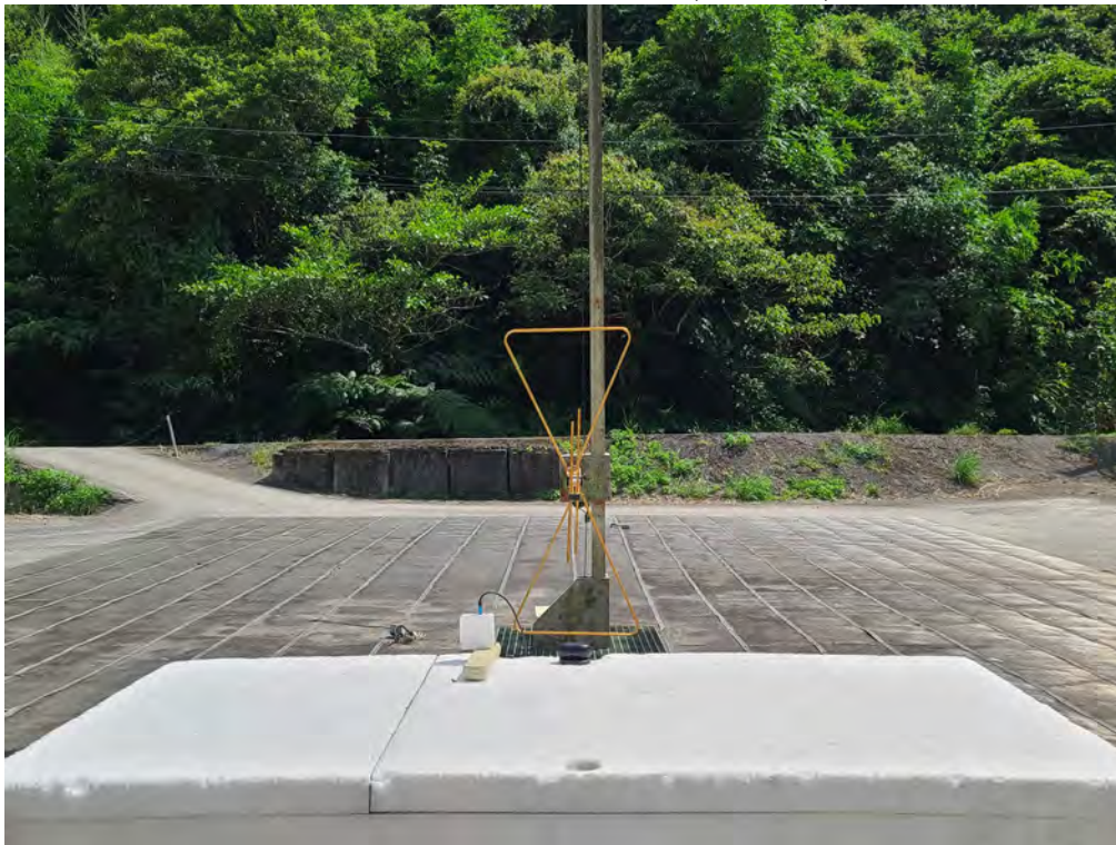
輻射干擾量測之配置照片(1G 以下)
