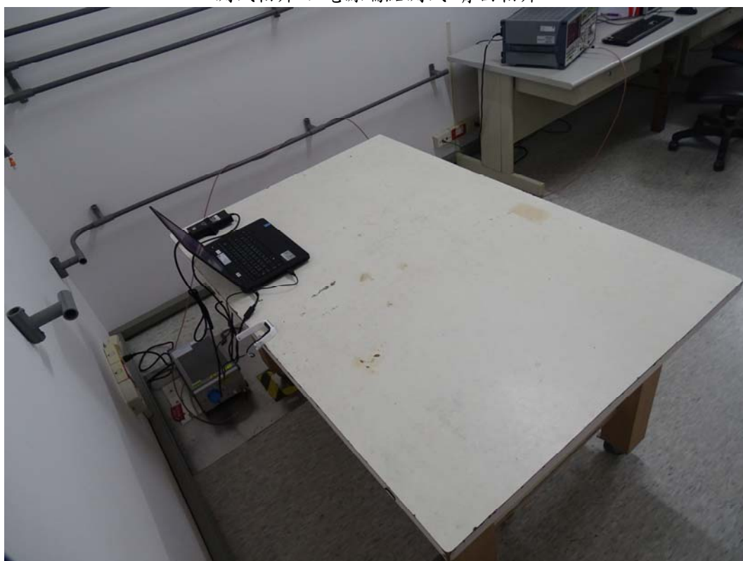
測試相片：電源端點測試 背面相片
