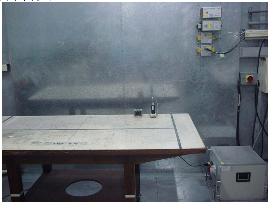
電源線傳導量測
