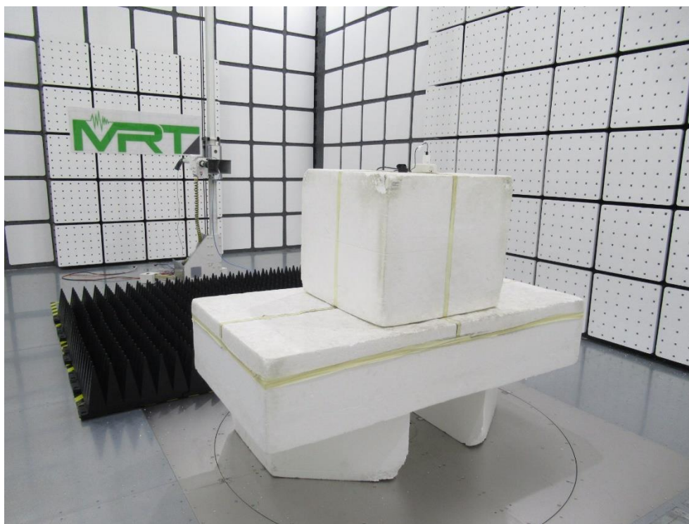
測試模式: Mode4 輻射測試 Above 1GHz
