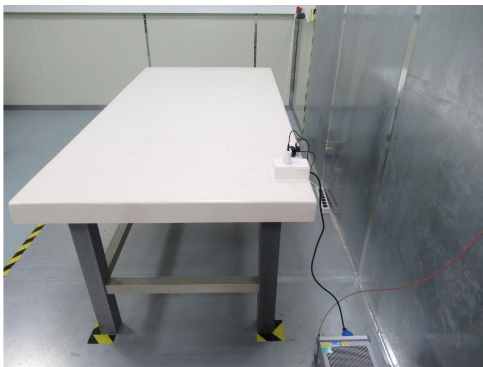
測試模式: Mode 4 電源傳導測試 側面照 - 0.15MHz ~ 30MHz
