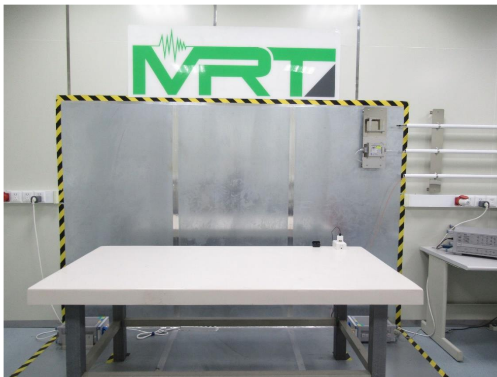
測試模式: Mode 4 電源傳導測試 側面照 - 0.15MHz ~ 30MHz
