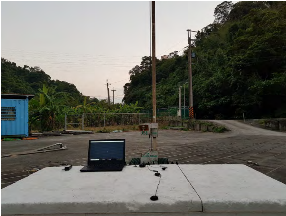
輻射干擾量測之配置照片(1G 以上)
