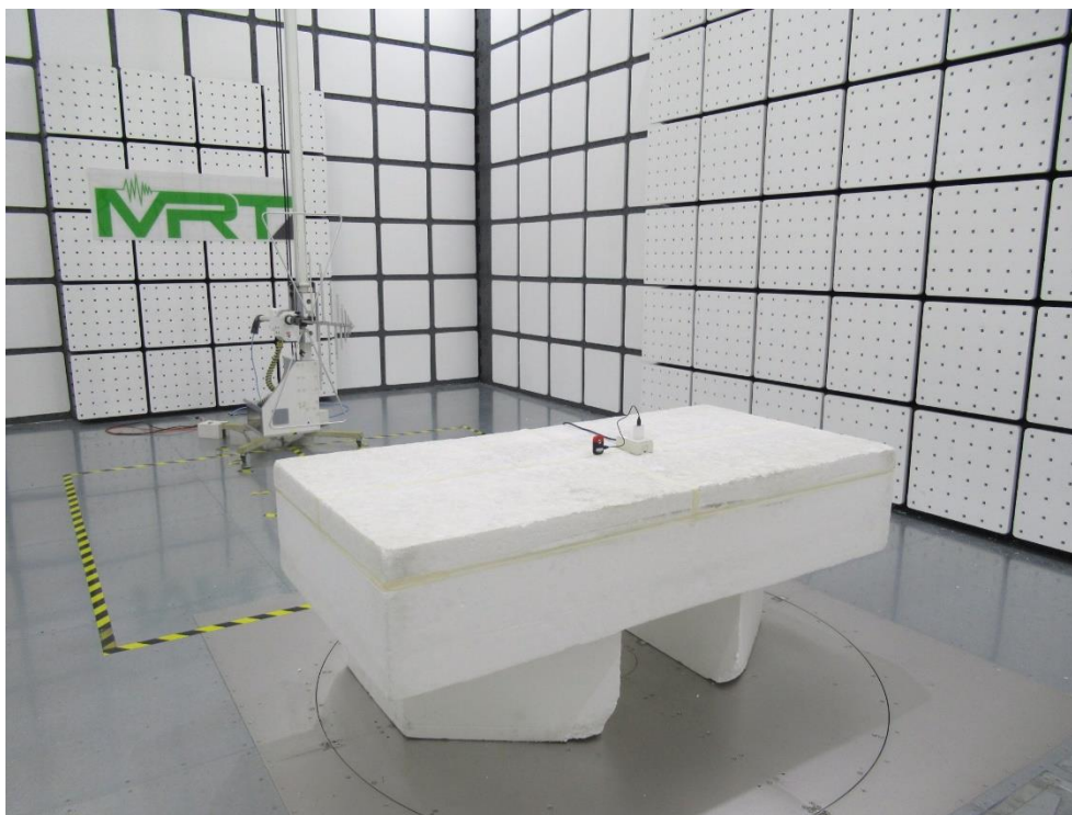
輻射測試 Above 1GHz
