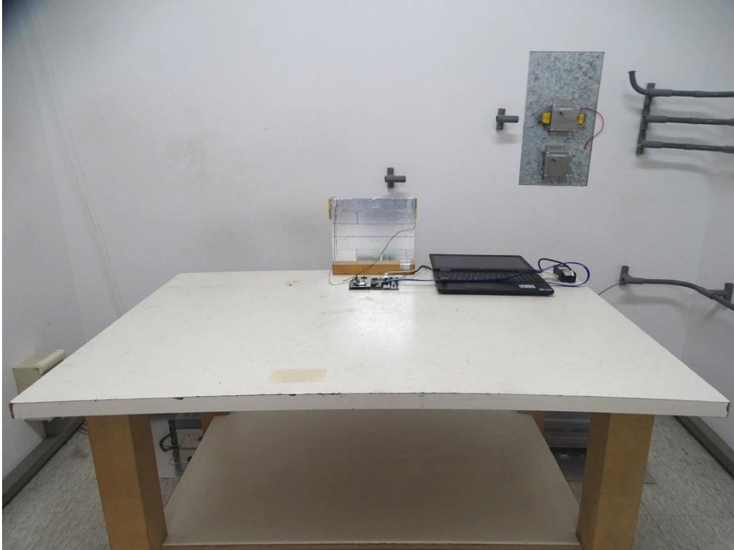
測試相片：電源端點測試 正面相片
