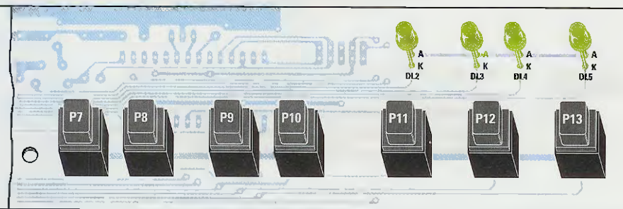
Fig.17 Dal lato opposto di questo stampato dovreste inserire i 5 display e i 13 pulsanti. Il terminale più lungo dei diodi led (vedi A) va rivolto verso l'alto.
