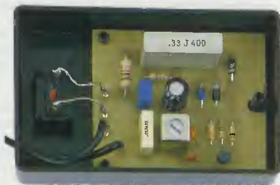
Fig.1 Foto dello stadio trasmettente già inserito all'interno del suo mobile plastico. Per evitare che tirando il cordone di rete i suoi fili si possano distaccare dai due terminali posti sul circuito stampato, consigliamo di fare un nodo sul cordone (vedi fig.6).
