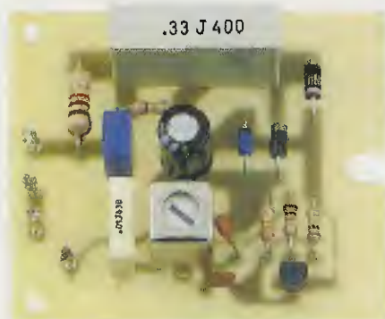
Fig.7 Foto della basetta dello stadio trasmittente con sopra già montati tutti i suoi componenti. Si noti vicino a DS1 il piccolo diodo zener DZ1.
