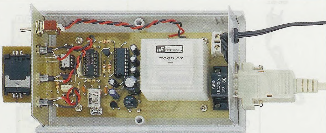
Fig.25 La basetta già montata va inserita dentro il suo mobile plastico, completo di mascherina frontale forata e serigrafata. Dal frontale di questo mobile fuoriesce il connettore provvisto di sportellino per inserire la Sim Card (vedi fig.1).
