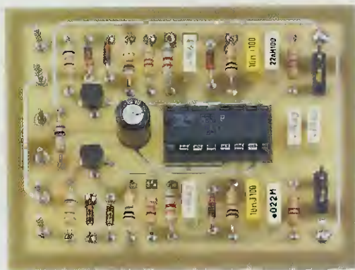
Fig.4 Ecco come si presenta la scheda già completa dei suoi componenti, esclusi i due soli potenziometri R6-R11. Il circuito stampato inserito nel kit risulta già forato e completo di disegno serigrafico.
