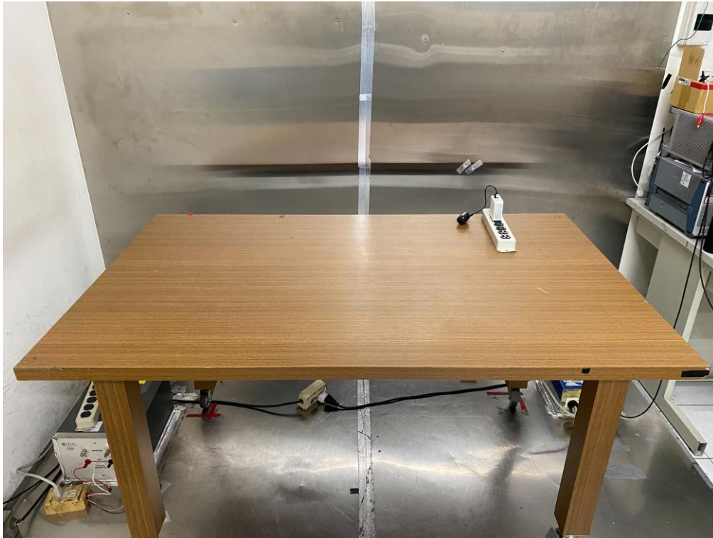
測試照片 傳導干擾量測之配置照片
