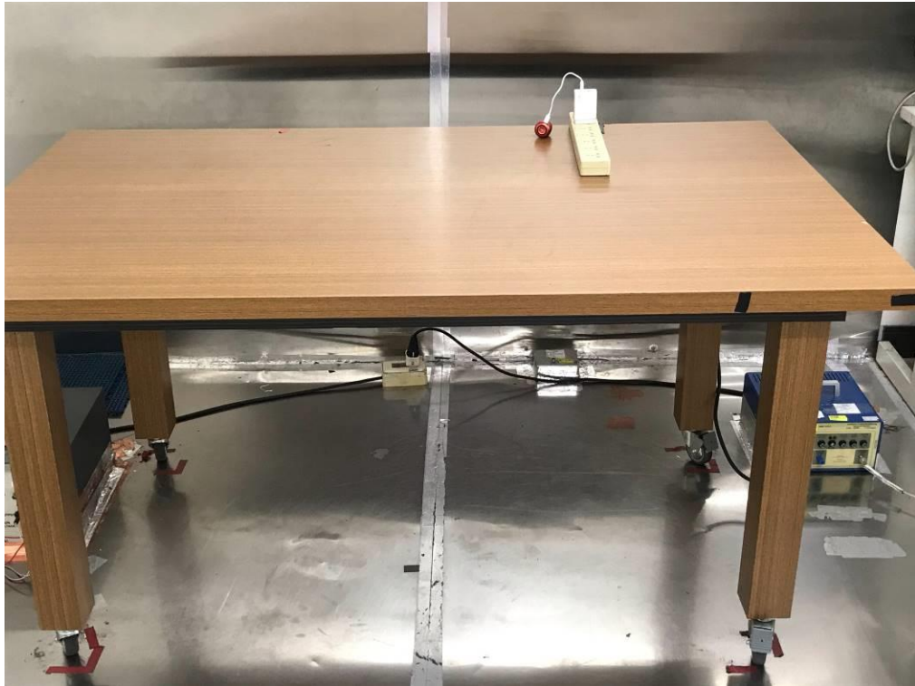
測試照片 傳導干擾量測之配置照片
