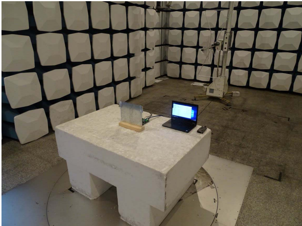
測試相片：輻射測試 正面相片
