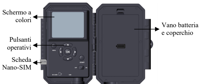
Figura 4: Vista interna e scheda SIM preinstallata
