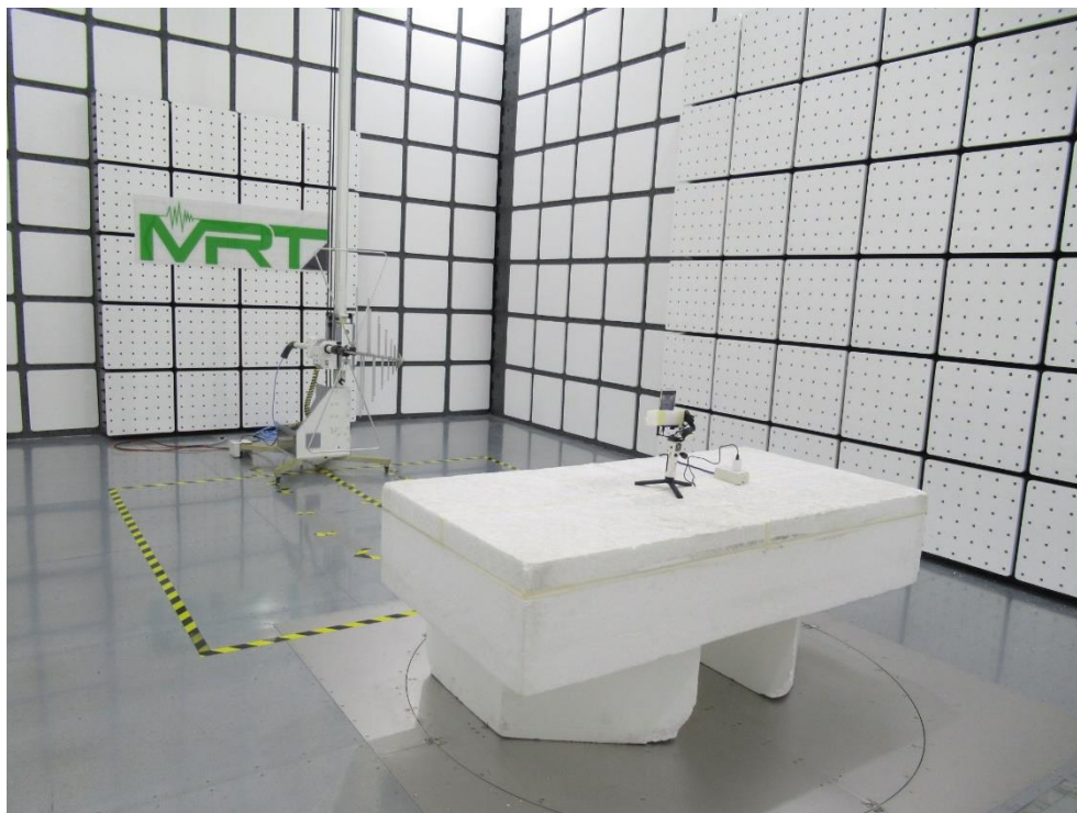
測試模式: Mode 3 輻射測試 Above 1GHz
